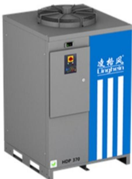
为了得到更干燥的空气，在使用螺杆空压机时往往会配套冷冻式干燥机使用。环境对于冷冻式干燥机的影响较大，过高或过低的环境温度都会使设备运行不流畅，环境温度过高会导致风冷型冷干机冷媒冷凝压力增大，使制冷量下降，增加设备出口压力；环境温度过低，特别是低于0℃后，冷干机冷凝水外排时易发生冰堵。相反，环境对吸附式干燥机的影响较小，它能很强的适应温度环境的变化，只是在设备选型时须考虑到比较高环境温度下空压机出口温度高导致的压缩空气压力值高的影响因素。在使用螺杆式空压机时，有些客户需要用到干燥机，选择合适的干燥机才能更好地提升使用效率，那么如何选择合适的干燥机呢？那么根据实际需求来选择是选择干燥机的首先要点。相比较与吸附式干燥机，冷冻式干燥机的能耗和运行成本较低，但是它无法提供干燥的压缩空气，而吸附式干燥机可以，冷冻式干燥机的压力通常在3°Ctd以上，对于一般的制造工艺而言，选择冷冻干燥机是足够的；而对于一些要求更高、需要更干燥的压缩气体时就应该选择吸附式干燥机。重庆变频永磁空气压缩机维修电话凌格风空压机降低您的投资成本。
